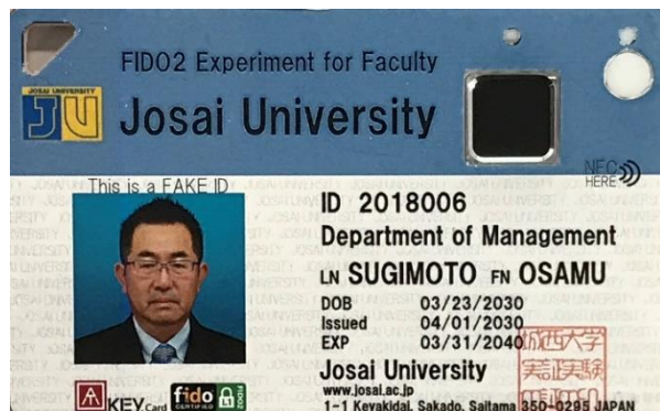
図2：キャンパス ID 型 FIDO2 セキュリティキー（多要素認証の弱点となっていた複数デバイス認証による利便性の棄損をシングルデバイス認証として実現・解決した：所持+生体）
